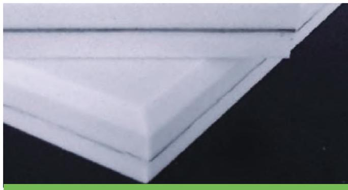
Desenvolvido para uso em cabines de máquinas e grupos geradores, apresenta dupla função: absorção + isolamento acústico, devido à alta densidade da manta HD\*, aliada à placa de illtec, que aumenta o poder de isolamento de chapas metálicas, drywall, madeira ou mesmo alvenaria.
