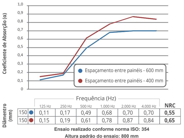
A curva de Coeficiente de Absorção Sonora ( $\alpha_s$ ) por frequência e o NRC equivalente foi calculado considerando as condições de espaçamento e plenum de cada ensaio. Nuvens e Baffles são sistemas de absorção não lineares em que, normalmente, considera-se a Absorção Sonora (A) em  $m^2$  por unidade para cada frequência.
